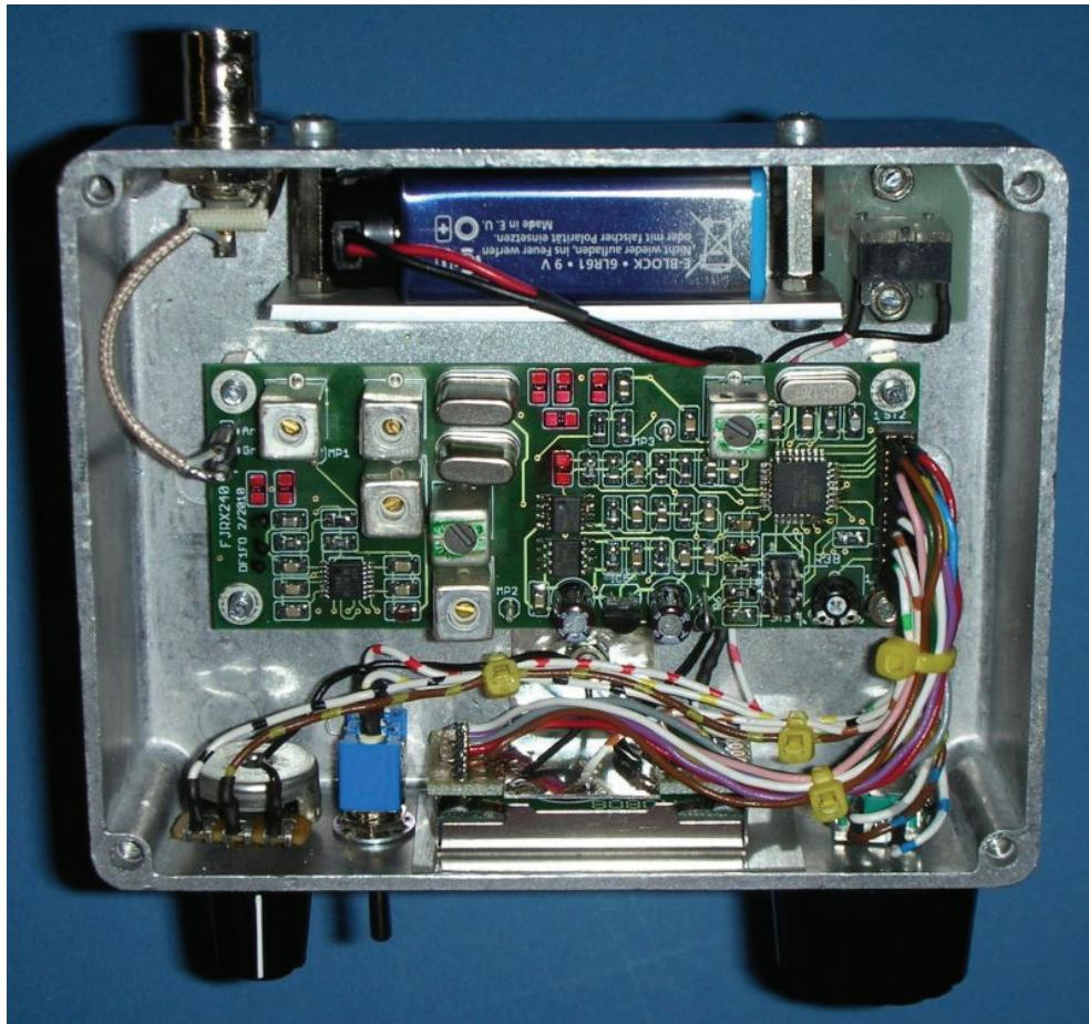
Die Platine wird mit 10mm langen Distanzbolzen genau in die Mitte des Gehäuses montiert. Hinten in der Mitte halten ein Blechstreifen und zwei Distanzbolzen die Batterie. Die Hörerbuchse, im Bild oben rechts, ist isoliert ein gebaut.
