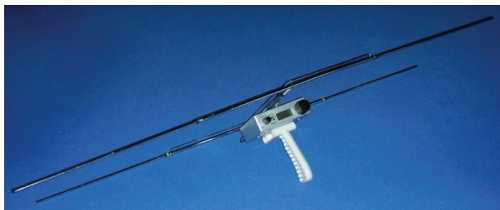
Die Antenne – eine **HB9CV** – wird oben auf den Empfänger aufgesetzt.
