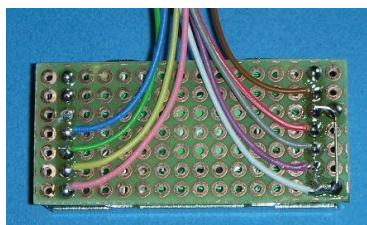
Das Display wird auf ein Stück Lochrastermaterial (ca. 20x40mm) montiert. Ein aus einem Streifen Weißblech gebogener Winkel drückt das Display gegen die Frontplatte. Er ist mit einer Schraube am Boden befestigt, und wird, wenn das Display richtig sitzt, mit der Lochrasterplatine verlötet. Der Winkel ist zugleich der zentrale Massepunkt, an den alle Masseleitungen angelötet werden. Zwischen Display und Frontplatte schiebe ich als Regenschutz ein Stück klaren Kunststoff von einer Blisterpackung.
